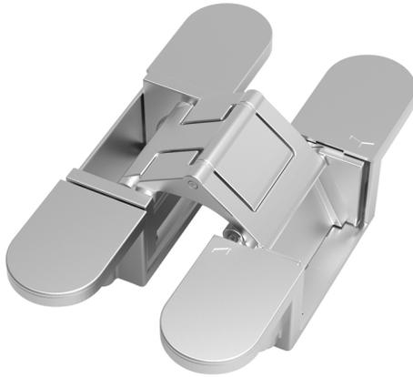
Charnière invisible EXO XC-10 au design pur sans vis apparentes et de haute qualité. Charnière technique, conçue pour tourner au-delà d'une plinthe ou d'un revêtement mural, grâce à sa distance d'encastrement variable (de 4 à 10 mm) jusqu'à l'avant du panneau de porte.
