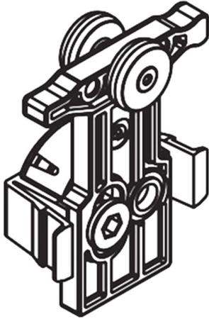
Clipo 26/36 H IS pour deux vantaux bois à roulement haut. Idéale pour les solutions de rangement semi-hautes. Elle n'exige ni rainure au sol, ni cache. Le rail de roulement est inséré dans une rainure. Amortissement invisible, avec fermeture automatique par traction et ressort, et intégré au rail. Chariot de roulement clipsable, rapide et sans outil.
