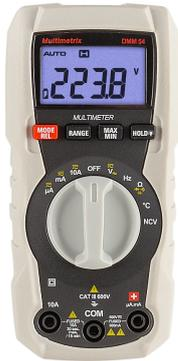
Afficheur numérique rétroéclairée 4000 points sélection automatique de calibre tension, intensité, résistance, continuité, diode, capacité, fréquence, température/ NVC extinction automatique indicateur de piles usées protection par fusibles de sécurité à haut pouvoir de coupure poids : 210g fourni avec : 1 jeu de cordon à pointe de touche Ø2mm bi-mode CAT II/ CAT III-IV, 1 thermocouple, 1 adaptateur, 2 piles 1.5V AAA.
