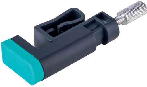
P uissance de serrage 30K g ouverture jusqu'à 24 mm augmente les possibilités d'utilisation des serre-joints à rail outil de serrage spécial pour l'encollage de bandes de chant ou de moulures pour le serrage d'appoint en plein panneau (p. ex. moulure de porte) accessoire pour tous les serre-joints à rails de section 8 x 30 mm max. (serre-joints à une main ou serre-joints à vis) .
