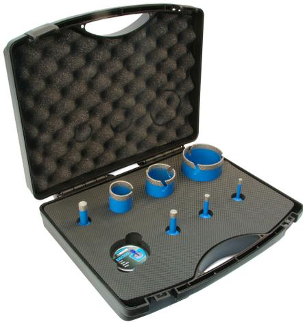
Longueur utile du tube : Ø 6 à 12 : 35 mm / au delà : 50 mm segments "vacuum brazed" : plus de résistance spécialement conçu pour les meuleuses d'angles et les perceuses coffret comprenant :- 7 couronnes raccord M14 Ø 06, 08, 10, 12, 35, 45 et 68 mm- 1 boîte de cire matériaux : carrelage, céramique, granit, grès cérame pleine masse, pierre naturelle raccord : M14 travail à sec.
